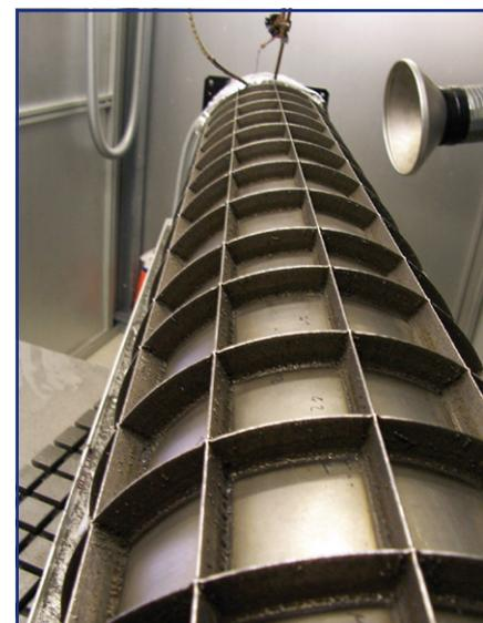
Rohr mit Strukturleichtbaukomponenten – erhöht Tragkraft und spart Gewicht (Innendurchmesser: 21 cm, Länge: 116,5 cm)
