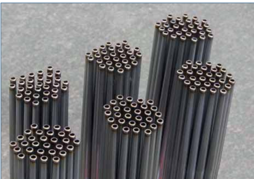
Foto links: Laser-Pulverauftragschweißen zur Verdickung dünnwandiger Rohre mit Wandstärken zwischen 0,4 und 0,6 Millimeter.
