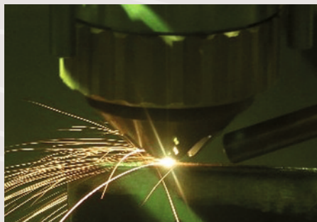
Prozess Auftragschweißen an Turbinenschaufeln
