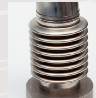
cw-Laserschweißen von flexiblen Metallbälgen mit Anschlussstück aus hochleg. CrNi-Stahl
