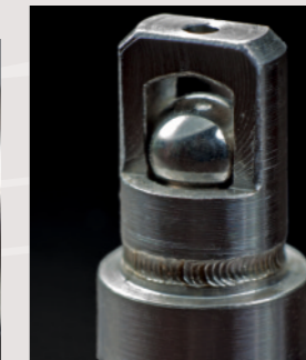
Lasereinschweißen an einem Ventil
