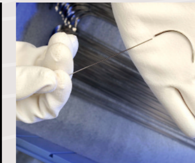
Operationsnadel vor dem Laserschweißen
