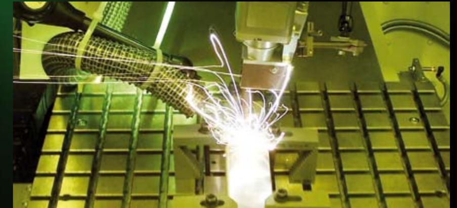
Aluminiumschweißung mit Faserlaser
