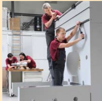
Montagearbeiten an einem Spezialbeton-Maschinengestell
