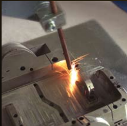
Änderungen an einem Spritzgusswerkzeug durch Pulver-Auftragschweißen
