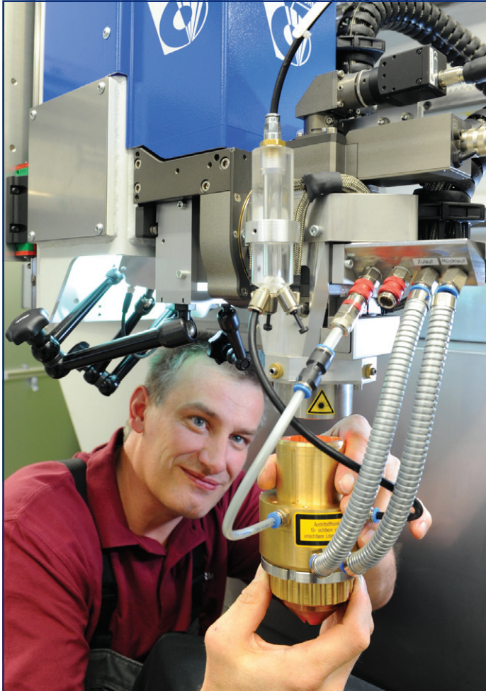
Aufbau einer Laseranlage zum Auftragschweißen. ©LASERVORM
