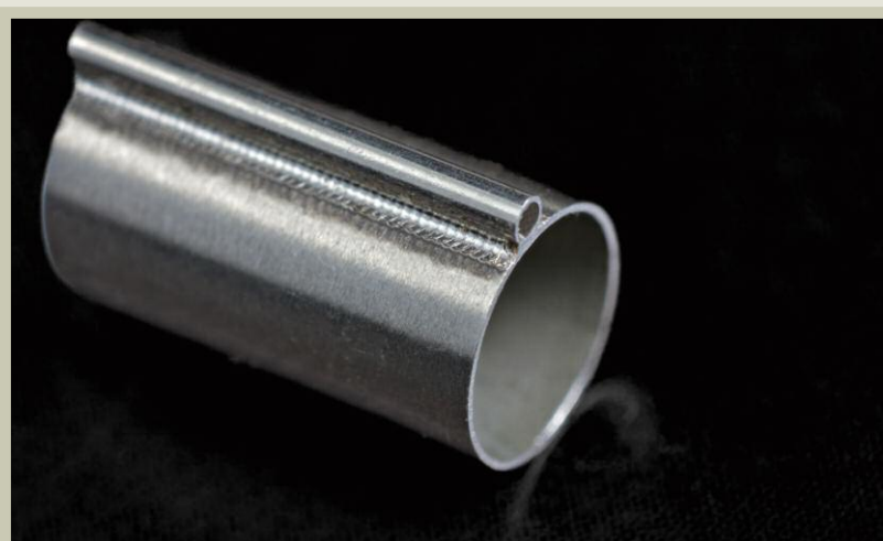
Bild 2. Verschweißung kleinster Rohre: typisches Anwendungsbeispiel für ein hervorragendes Bearbeitungsergebnis durch zeitliche Strahlmodulation
