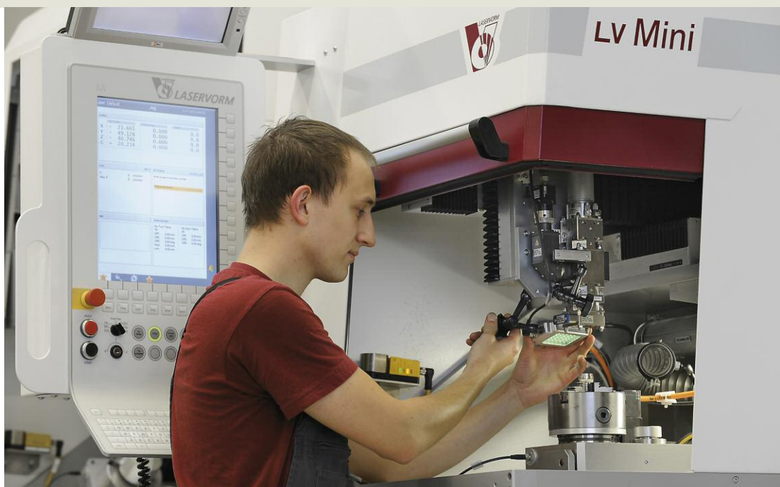
Bild 1. Besonders kompakte Laseranlage ›LV Mini‹ mit programmierbarer Strahlqualität
