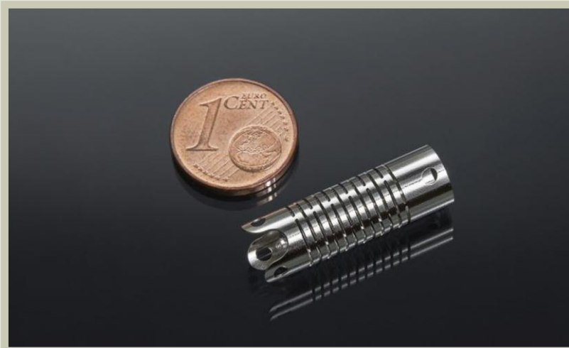
Bild 3. Schneiden eines Festkörpergelenks: Die Anlage kann sehr variabel an die Bearbeitungsaufgabe angepasst werden
