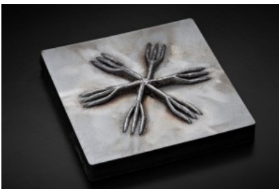
Bild 2: Beispiel einer programmierbar ausgebildeten Auftragschweißraupengeometrie
