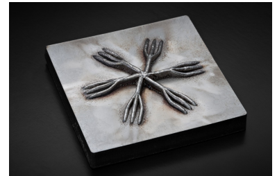
Dank der Option 'programmierbare Strahlqualität' ist die raupenbreite steuerbar.
